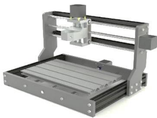
Gambar 4.1 Hasil perancangan mesin CNC Router 3 Axis menggunakan Software AutoCAD 3 dimensi
